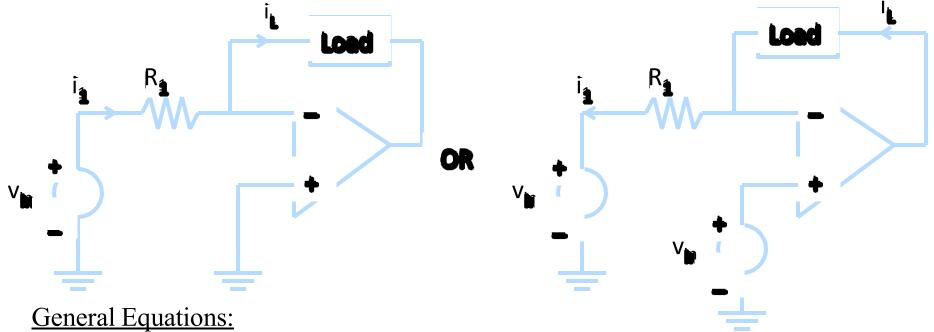
$$i_L = i_1 = v_1 / R_1$$
