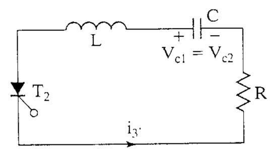
$$L\frac{di_3}{dt} + Ri_3 + \frac{1}{C} \int i_3 dt + v_{C_3}(0) = 0$$
