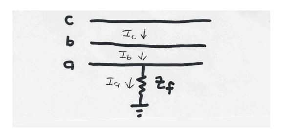
$$\begin{bmatrix} I_a^f \\ I_b^f \\ I_c^f \end{bmatrix} = \begin{bmatrix} ? \\ 0 \\ 0 \end{bmatrix}$$
