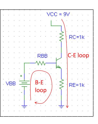
$$V_{BB} = I_B R_{BB} + V_{BE} + I_E R_E$$
